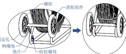
图 20.安装滚轮组件
