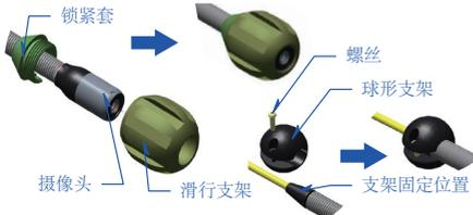
图 15.安装78 滑行支架
