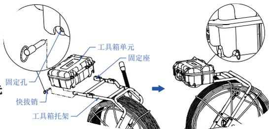
图 19.安装工具箱单元
