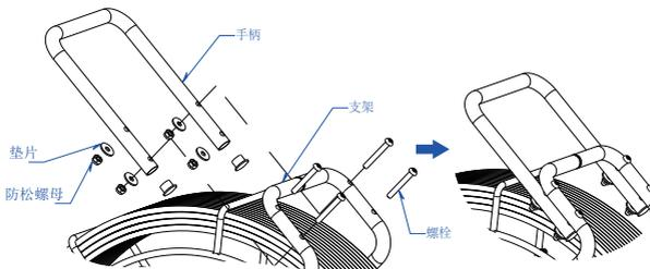
图 17.安装延长手柄
