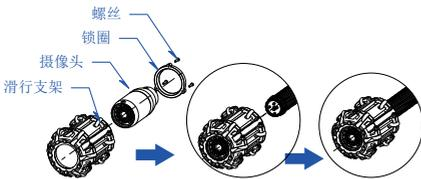
图 13.安装72 滑行支架
