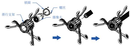
图 14.安装120 滑行支架
