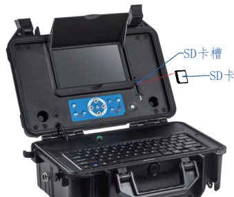
图 12. 安装 SD 存储卡
